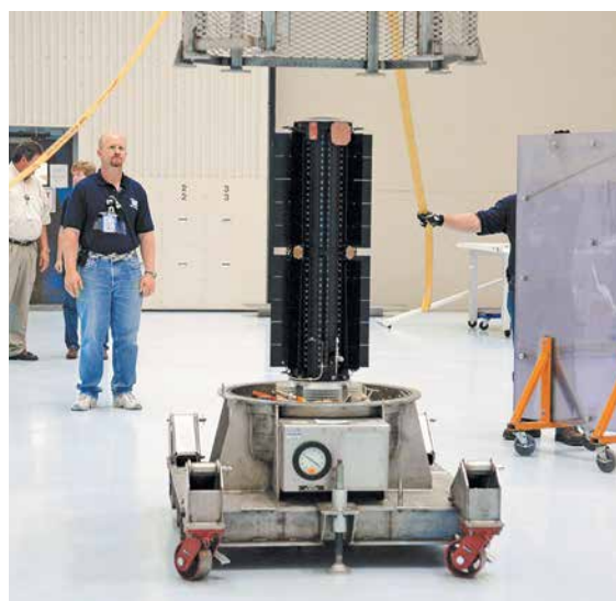
РИТЭГ космического аппарата New Horizons
