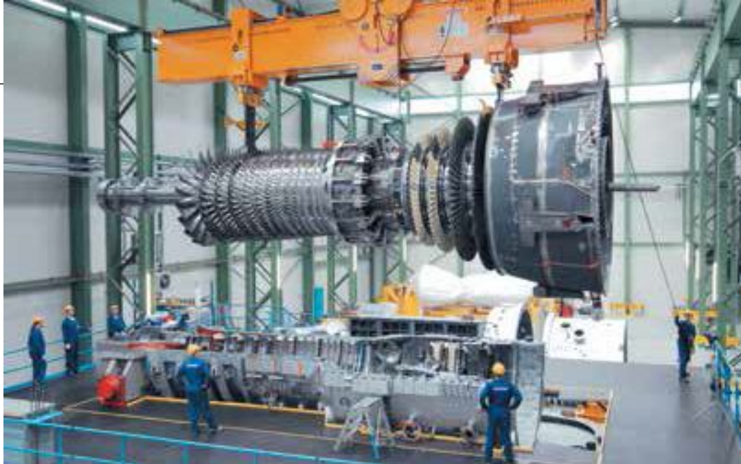
Газовая турбина Siemens SGT5-8000H на заводе газовых турбин в Берлине, финальная стадия сборки
